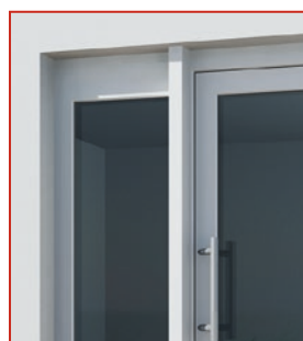
Um eine hohe Stabilität und Langlebigkeit zu gewährleisten, wird bei Kunststofftüren mit Seitenteil eine Statikzarge auf den senkrechten Pfosten gesetzt.
