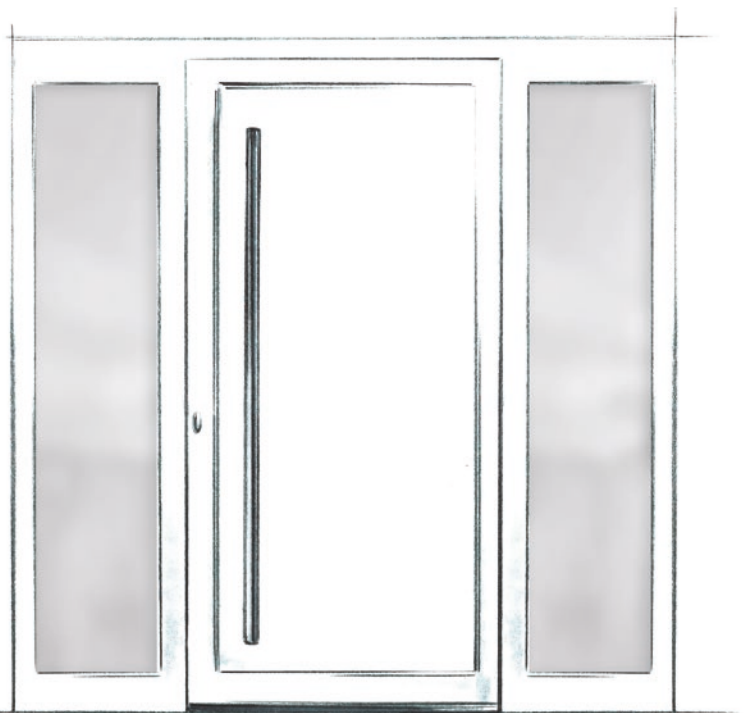
Konstruktion mit zwei festen Seitenteilen
